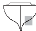
Figure 3 : emplacements recommandés pour le capteur
